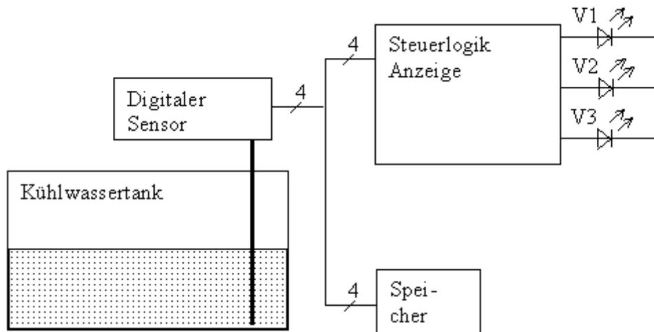
6.1 Der Füllstand in einem Kühlwassertank wird über einen digitalen Sensor dual kodiert im Bereich von 0 bis 1,10 m im Abstand von 10 cm gemeldet. Unterschreitet der Füllstand einen Wert von 0,50 m soll das durch eine rote LED V1 angezeigt werden. Im Normalbereich von 0,50 m bis 0,90 m soll die grüne LED V2 und im Bereich über 0,90 m die gelbe LED V3 leuchten.
